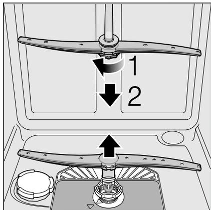
4. Промойте распылительные коромысла в проточной воде.
